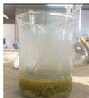
**Figura 1.** Reação ácido/argamassa, e pode-se ver o Resíduo Insolúvel (areia) depositada no fundo do Becker.
