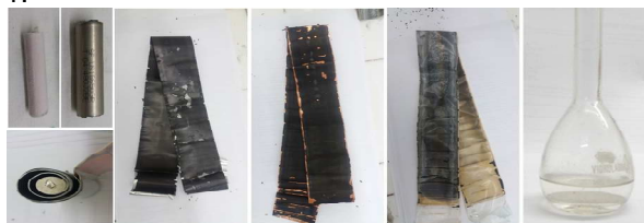
Figura 1. Componentes da bateria descartada de íons de lítio separados através do processo individualizado de abertura.
