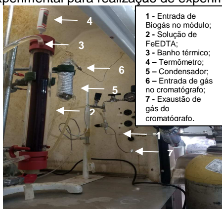
Figura 1. Modelo experimental para absorção de H 2 S.
