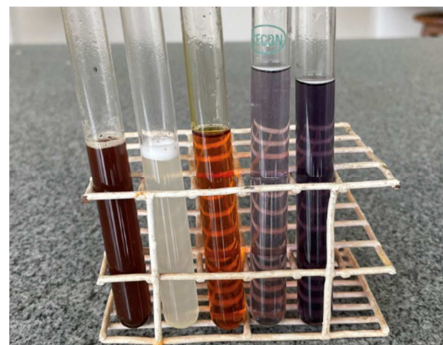
Figura 1. Amostras de café durante a análise para detecção de fraudes. Da esquerda para direita: 1) amostra não tratada; 2) amostra já clarificada; 3) resultado negativo; 4) resultados positivos com 8% de cevada torrada; 5) resultado positivo com 16% de cevada torrada.
