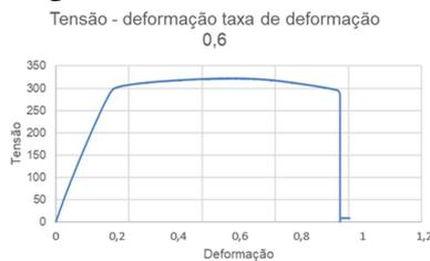
Figura 1. gráfico tensão-deformação liga TiAlV temperatura ambiente.
